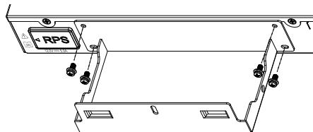
**Passo 3:** Coloque o RPS horizontalmente no suporte. Certifique-se de que o cabo de alimentação esteja localizado na lateral do plugue de silicone do RPS.
