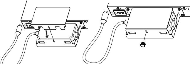
**Шаг 5:** Поднимите силиконовую заглушку RPS со стороны стрелки и поверните ее на 90° по часовой стрелке, чтобы увидеть отверстие питания, затем подключите RPS к коммутатору, затем подключите шнур питания переменного тока к RPS, наконец, подключите кабель питания в систему электропитания.
