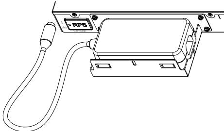
**Шаг 4:** Опустите крышку кронштейна и убедитесь, что отверстия для винтов совмещены. Затем с помощью винта (M3\*6) зафиксируйте RPS в кронштейне.
