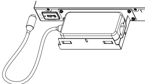
**Paso 4:** Baje la tapa del soporte y asegúrese de que los orificios de los tornillos estén alineados. A continuación, utilice el tornillo fijo (M3\*6) para asegurar el RPS dentro del soporte.
