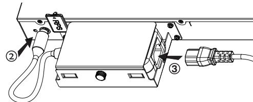
步骤 6: 为防止电源以外断开，可以使用电源线防脱扣进行固定。将固定带光滑的一面朝向电源线，接入电源线下方的防脱扣孔里。
