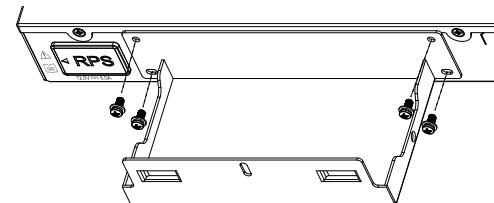
**Paso 3:** Coloque el RPS horizontalmente en el soporte. Asegúrese de que el cable de alimentación se encuentre en el lado del enchufe de silicona del RPS.
