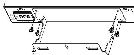
**Passaggio 3:** Posizionare l'RPS orizzontalmente nella staffa. Assicurarsi che il cavo di alimentazione si trovi sul lato del tappo in silicone dell'RPS.
