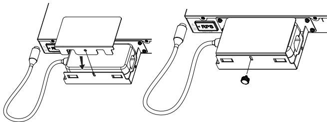
步骤 5: 从箭头侧揭开RPS硅胶塞，顺时针旋转90°，即可见电源孔。先将RPS连接到交换机，然后将交流电源线连接到RPS，最后完成电源线与电源供电系统之间的连接。
