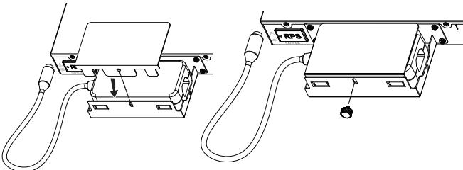
**Passaggio 5:** Sollevare il tappo in silicone dell'RPS dal lato con la freccia e ruotarlo di 90° in senso orario per esporre il foro di alimentazione; collegare l'RPS allo switch, quindi collegare il cavo di alimentazione CA all'RPS e, infine, completare il collegamento tra il cavo di alimentazione e il sistema di alimentazione.
