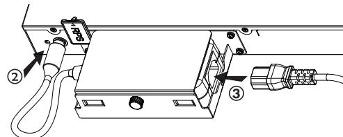
**Passaggio 6:** Per evitare scollegamenti accidentali dell'RPS, si consiglia l'uso di un cavo di alimentazione anti-trip. Posizionare il lato liscio della fascetta fissa verso la cavo di alimentazione e collegarla al foro anti-trap sotto il cavo di alimentazione.
