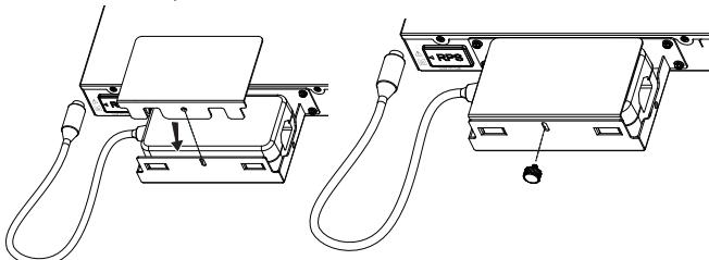
**Passo 5:** Levante o plugue de silicone do RPS do lado da seta e gire-o 90° no sentido horário para ver o orifício de alimentação, em seguida conecte o RPS ao switch, conecte o cabo de alimentação CA ao RPS e, finalmente, conclua a conexão entre o cabo de alimentação e o sistema de alimentação.
