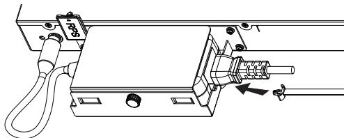
**Paso 7:** Deslice la cuerda protectora sobre la correa fija hasta el extremo del cable de alimentación, luego enrolle suavemente la correa alrededor del cable de alimentación y asegúrela firmemente.
