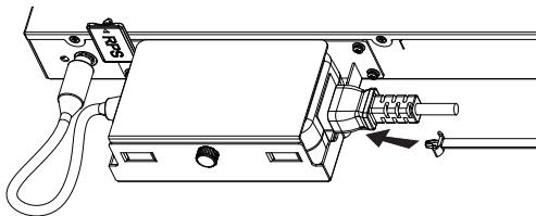
**Passaggio 7:** Far scorrere il cavo di protezione sulla fascetta fissa sino alla fine del cavo di alimentazione, quindi avvolgere in modo uniforme la fascetta intorno al cavo di alimentazione e bloccarlo saldamente.
