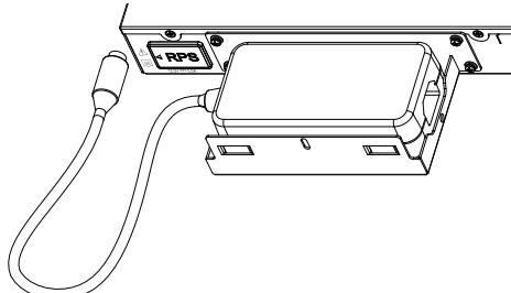
**Étape 4:** Abaissez le couvercle du support et assurez-vous que les trous de vis sont alignés. Ensuite, utilisez la vis fixe (M3\*6) pour verrouiller le RPS à l'intérieur du support.
