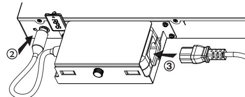
**Schritt 6:** Um ein versehentliches Trennen des RPS zu verhindern, wird empfohlen, bei der Installation eine Abreißsicherung für das Netzkabel zu verwenden. Legen Sie die glatte Seite des Schellenbandes in Richtung des Netzkabels und verbinden Sie es mit dem Einklemmschutzloch unter dem Netzkabel.
