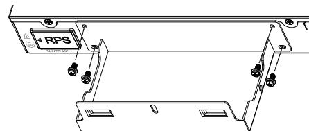
**Étape 3:** Placez le RPS horizontalement dans le support. Veuillez vous assurer que le cordon d'alimentation est situé sur le côté de la prise en silicone RPS.
