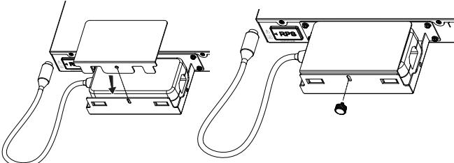
**Étape 5:** Soulevez la prise en silicone RPS du côté de la flèche et faites-la pivoter de 90 ° dans le sens des aiguilles d'une montre pour voir le trou d'alimentation, connectez ensuite le RPS au commutateur, puis connectez le cordon d'alimentation secteur au RPS, enfin terminez la connexion entre le cordon d'alimentation et l'alimentation Système d'alimentation.
