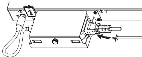
**Passo 7:** Deslize a corda protetora sobre a alça fixa até o final do cabo de alimentação e, em seguida, enrole suavemente a alça ao redor do cabo de alimentação e prenda-a firmemente.
