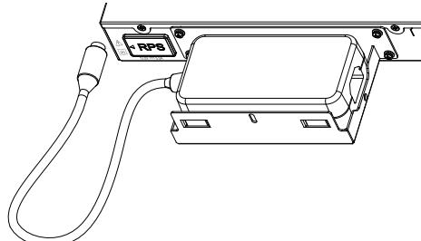
**Passo 4:** Abaixe a tampa do suporte e certifique-se de que os orifícios dos parafusos estejam alinhados. Em seguida, use o parafuso fixo (M3\*6) para travar o RPS dentro do suporte.
