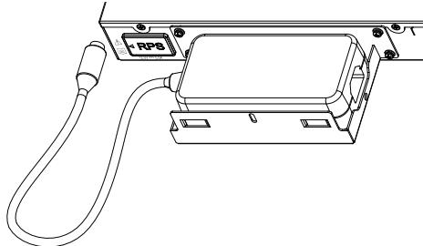
步骤 4: 步骤4: 合上支架盖子，确保螺丝孔位对齐。然后使用固定螺丝(M3\*6)将电源锁在支架内。
