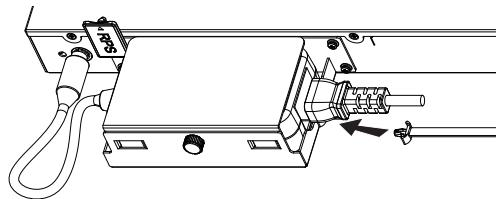
**Schritt 7:** Schieben Sie das Schutzseil über das Schellenband bis zum Ende des Netzkabels, schlungen Sie das Band dann gleichmäßig um das Netzkabel und fixieren Sie ihn fest.
