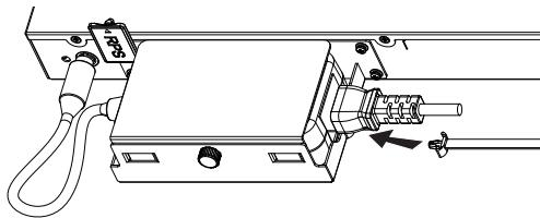
步骤 7: 将保护绳滑过固定带直至电源线末端，顺利将绑带绕在电源线上，并锁紧。
