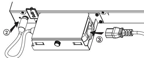
**Paso 6:** Para evitar una desconexión accidental del RPS, se recomienda utilizar un cable de alimentación antirretorno para la instalación. Coloque el lado liso de la correa fija hacia el cable de alimentación y conéctela al orificio antirretorno situado debajo del cable de alimentación.
