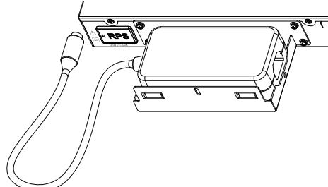
**Schritt 4:** Klappen Sie die Abdeckung der Halterung herunter und stellen Sie sicher, dass die Schraubenlöcher ausgerichtet sind. Verwenden Sie dann die Klemmschraube (M3\*6), um den RPS in der Halterung zu fixieren.
