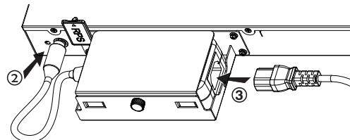
**Passo 6:** Para evitar a desconexão acidental do RPS, é recomendável usar uma unidade de fixação para a instalação do cabo de alimentação. Coloque o lado liso da alça fixa em direção ao cabo de alimentação e conecte-o ao orifício de fixação abaixo do cabo de alimentação.
