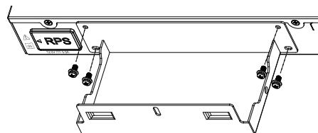
步骤 3: 将RPS电源水平放入支架。请确保电源线位于RPS硅胶塞侧。
