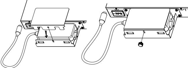
**Paso 5:** Levante el tapón de silicona del RPS por el lado de la flecha y gírello 90° en el sentido de las agujas del reloj para ver el orificio de alimentación, a continuación conecte el RPS al switch, después conecte el cable de alimentación AC al RPS, finalmente complete la conexión entre el cable de alimentación y el sistema de alimentación.
