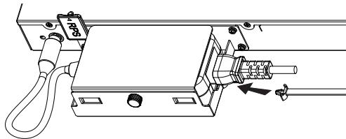
**Шаг 7:** Наденьте защитный трос на ремешок до конца шнура питания, затем плавно оберните ремешок вокруг шнура питания и плотно зафиксируйте его.
