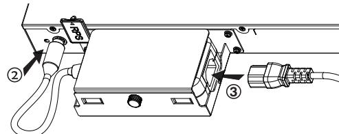
**Étape 6:** Pour éviter une déconnexion accidentelle du RPS, il est recommandé d'utiliser un cordon d'alimentation anti-trébuchement pour l'installation. Placez le côté lisse de la sangle fixe vers le cordon d'alimentation et connectez-le au trou anti-pincement sous le cordon d'alimentation.
