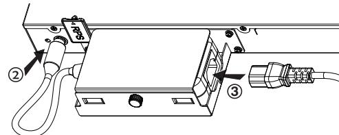
**Шаг 6:** Для предотвращения случайного отключения RPS при установке, рекомендуется использовать антизахват для шнура питания. Расположите гладкую сторону ремешка в направлении шнура питания и подсоедините его к отверстию антизахвата под шнуром питания.
