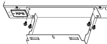
**Schritt 3:** Setzen Sie den RPS waagerecht in die Halterung. Achten Sie darauf, dass sich das Netzkabel an der Seite des RPS-Silikonsteckers befindet.
