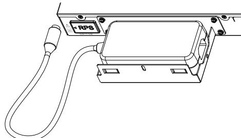
**Passaggio 4:** Abbassare il coperchio della staffa e assicurarsi che i fori filettati siano allineati. Quindi utilizzare la vite fissa (M3\*6) per bloccare l'RPS all'interno della staffa.
