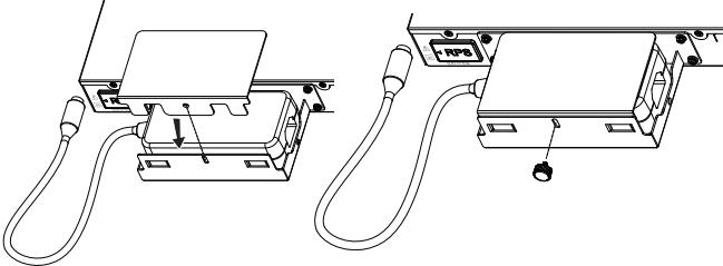
**Schritt 5:** Heben Sie den RPS-Silikonschluss von der Pfeilseite her an und drehen Sie ihn um 90° im Uhrzeigersinn, um die Stromversorgungsöffnung zu sehen, schließen Sie dann den RPS an den Switch an, verbinden Sie das Netzkabel mit dem RPS und stellen Sie schließlich die Verbindung zwischen dem Netzkabel und dem Stromversorgungssystem her.
