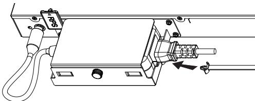
**Étape 7:** Faites glisser la corde de protection sur la sangle fixe jusqu'à l'extrémité du cordon d'alimentation, puis enroulez doucement la sangle autour du cordon d'alimentation et verrouillez-la fermement.
